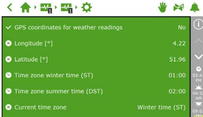
为了精确计算日出时间和日落时间，必须获得系统的 GPS 位置。如果 Meteo-Go! 气象站连接到系统中，则其 GPS 位置将通过内置 GPS 芯片自动测定。
